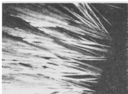
Abbild. 3. Beim Abkühlen isomorphe Vorwachsen der Kristallisationsfront.
